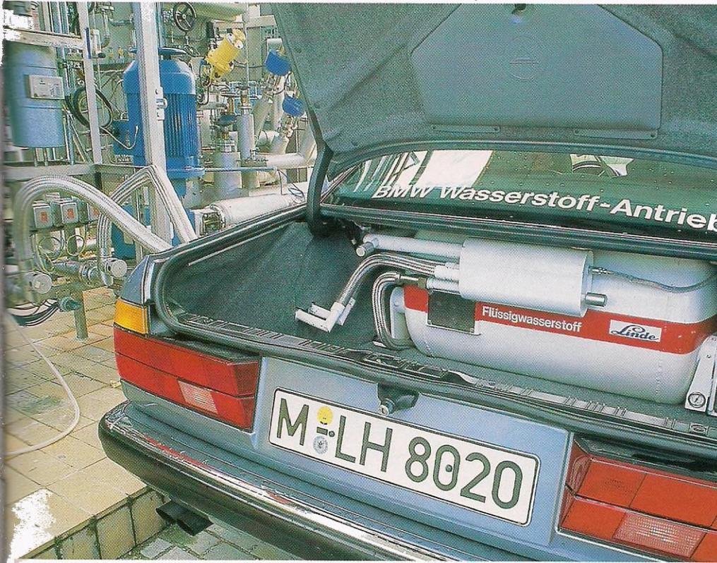
سيارة تُعبأ بوقود الهيدروجين السائل. ويمكن الحصول على الهيدروجين من الماء بفلق جزيئات الماء بالتحليل الكهربائي (الكهولة). وتوفّر القدرة اللازمة لذلك من خلايا قُطائِيّة ضوئيّة - تُنتج قوّة دافعة كهربائيّة بتحويل الطاقة الضوئيّة إلى طاقة كهربائيّة.
